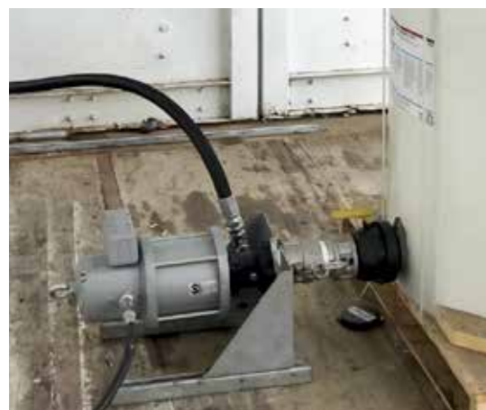
Их хэмжээний тосолгоонд зориулсан ёмкостонд хэвтээ суурилуулсан насосны иж бүрдэл
